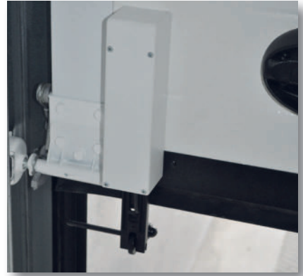
Fotocellula di sicurezza TSD
